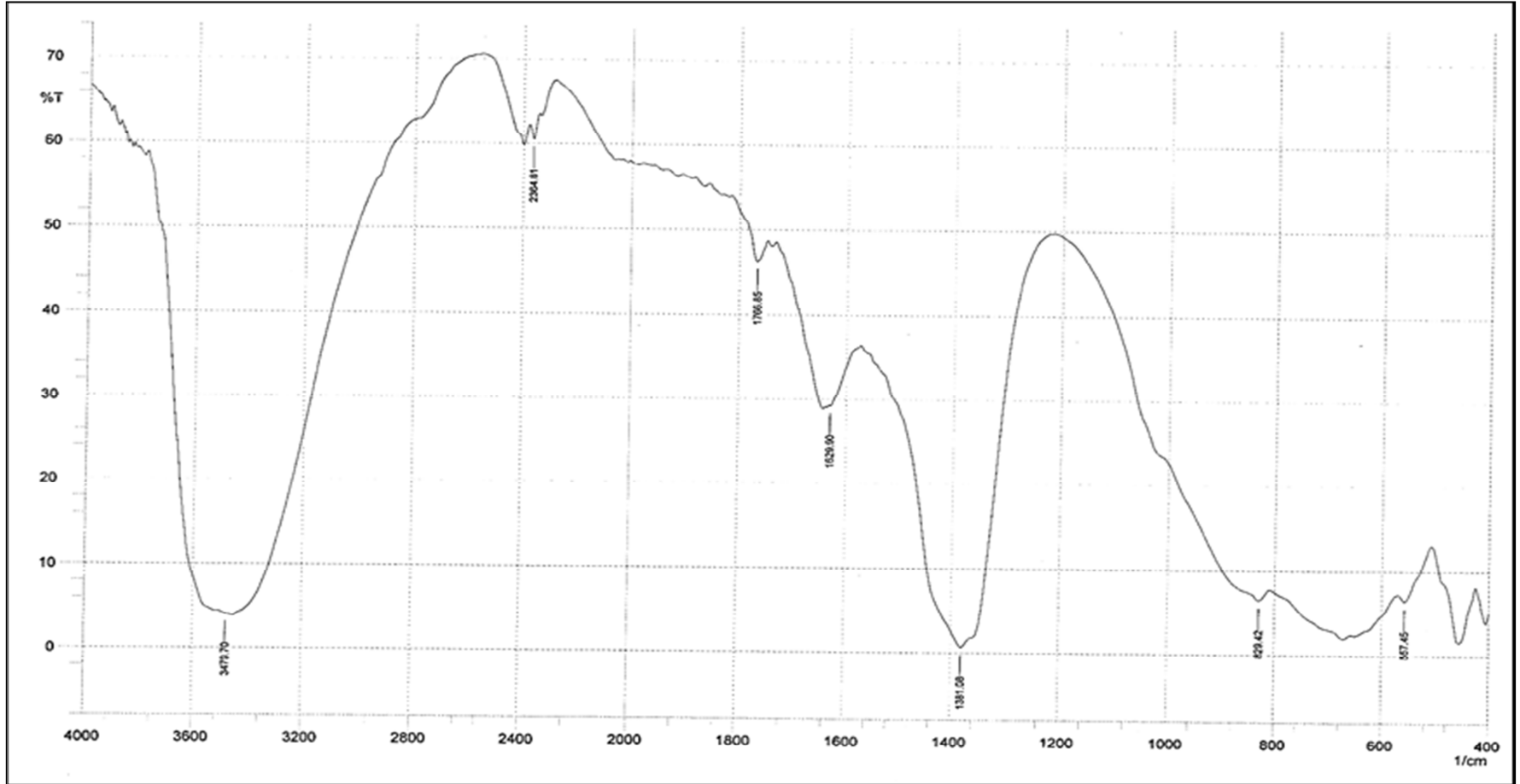
الشكل 5 : طيف الأشعة تحت الحمراء لطبقات المغنيسيوم\الألمنيوم ثنائية الهيدروكسيد
