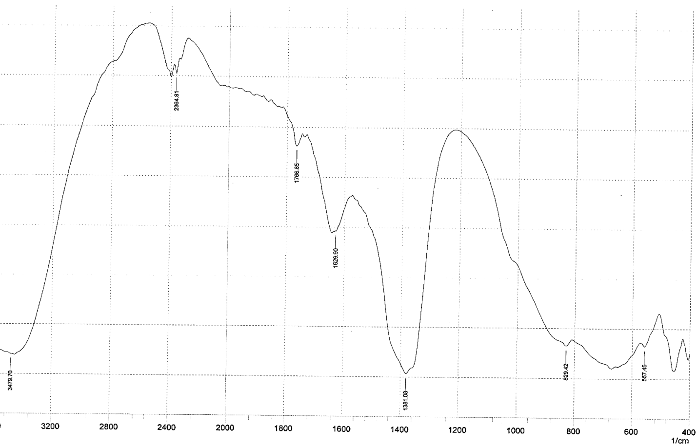
الشكل ( 9 ) : طيف الاشعة تحت الحمراء لطبقات المغنيسيوم/الالمنيوم ثنائية الهيدروكسيد
