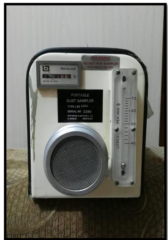
ملحق (4) جهاز جمع الدقائق العالق TSP (Sniffer) وصور المرشحات لكل منطقة.
