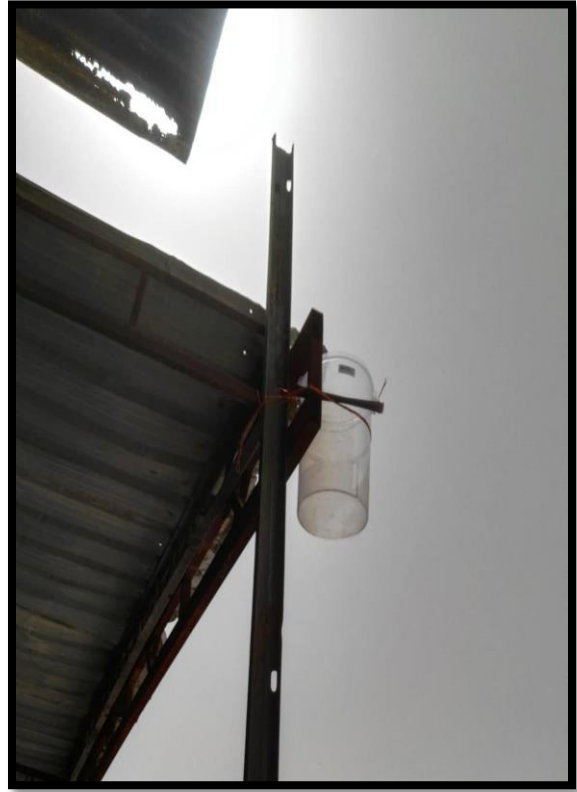
ملحق (1) أسطوانة جمع الغبار المتساقط في المنطقة الصناعية وكمية الغبار المتساقط فيها خلال شهر آذار.
