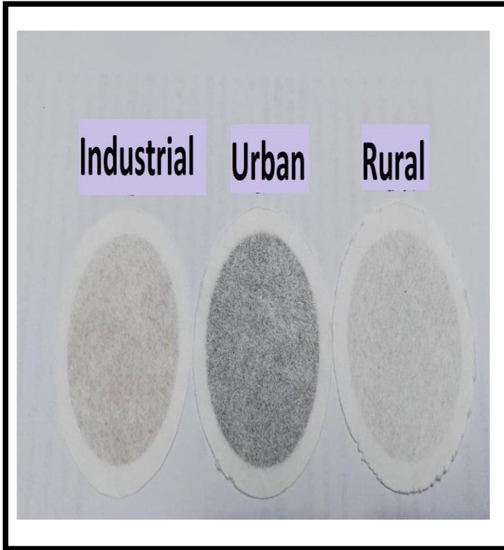
ملحق (4) جهاز جمع الدقائق العالق TSP (Sniffer) وصور المرشحات لكل منطقة.
