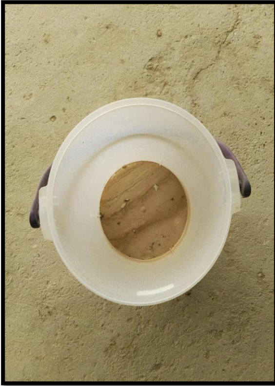
ملحق (1) أسطوانة جمع الغبار المتساقط في المنطقة الصناعية وكمية الغبار المتساقط فيها خلال شهر آذار.
