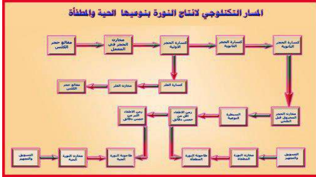
شكل (3-1) المسار التكنولوجي لإنتاج النورة بنوعها الحية والمطفأة
