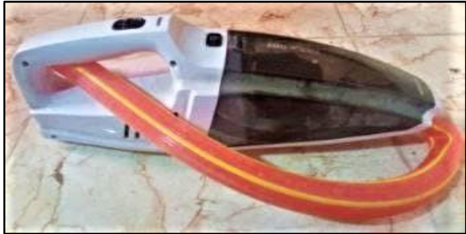
شكل (9): آلة جمع الحشرات المحورة. مكنسة شفط صغيرة تعمل بالشحن و تم ربط أنبوب بلاستيكي لها واغلاق الفوهة باحكام باستعمال الشريط اللاصق.
