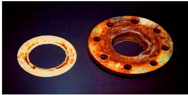
الشكل (1-9) يوضح التآكل الصدعي.
