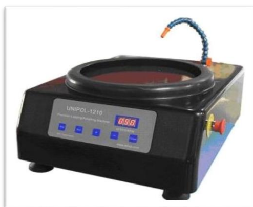
الشكل (2.1) يوضح جهاز الصقل
