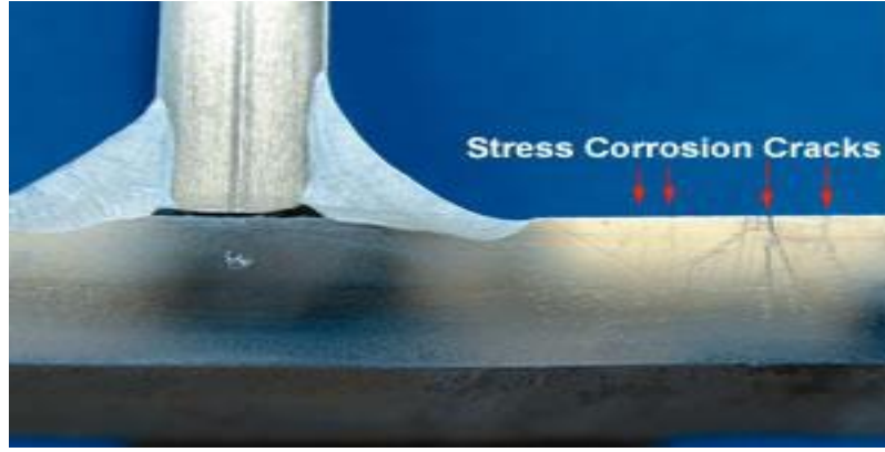
الشكل (1-5) يوضح التآكل الاجهادي.
