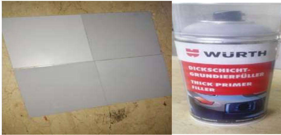
الشكل (2-5) يوضح كيفية تم وضع طبقة الاساس ( primer) على القطع المعدنية والشكل لنوعية البرايمر
