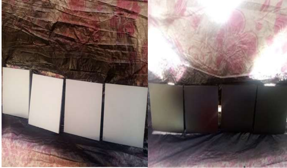
الشكل (2-7) يوضع طريقة رش الطلاء على العينات قبل الرش وبعده
