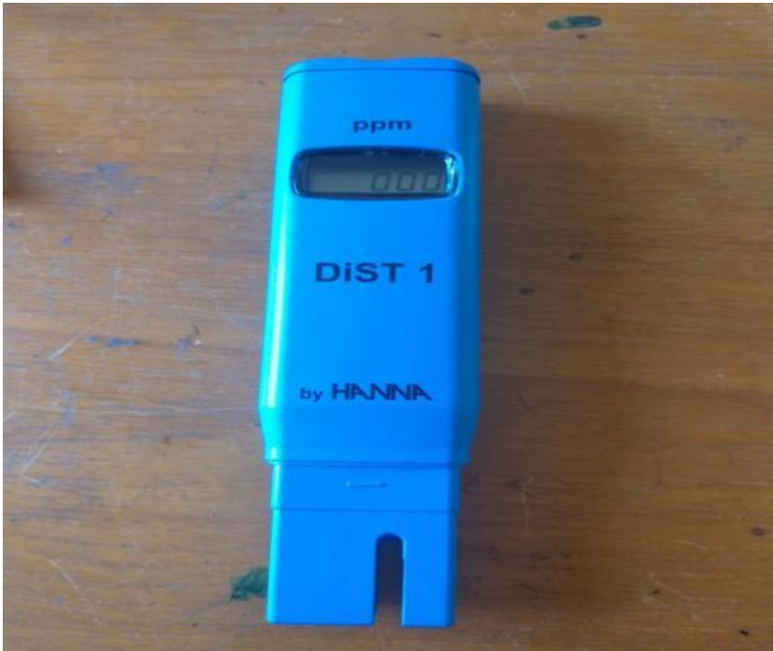
صورة رقم (2) توضح جهاز الايصالية الكهربائية (EC) لقياس نسبة الملوحة في مياه الري
