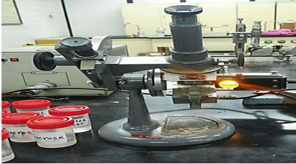
الشكل (3-7) صورة للمجهر الضوئي الذي تم استعماله لحساب معاملات الانكسار
