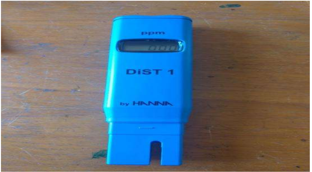
الملحق (3) توضح جهاز الايصالية الكهربائية (EC) لقياس نسبة الملوحة في ماء الري
