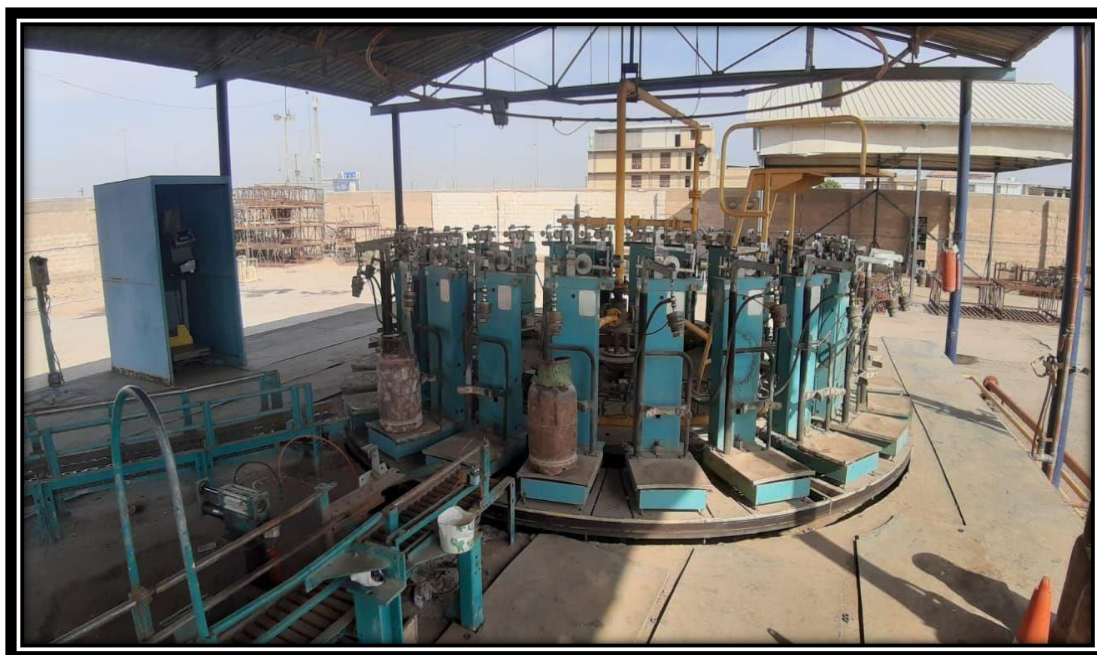
الصورة (8) طريقة التعبئة الميكانيكية.
