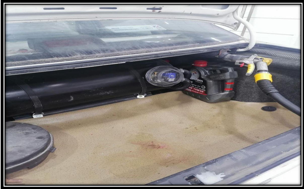
الصورة(31) منظومة تعبئة الغاز في السيارات.
