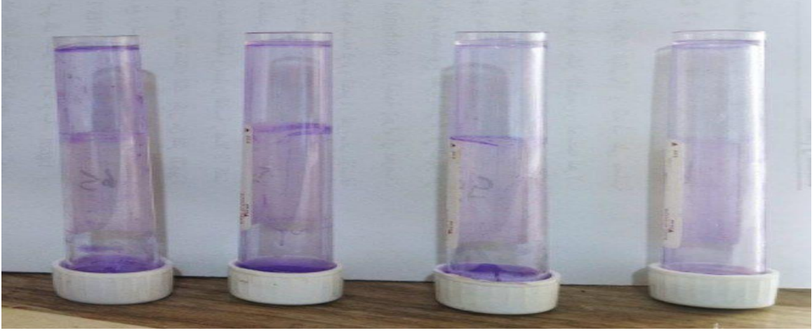
شكل (٤-٥): تكوين الأغشية الحيوية بطريقة الأنبوبة (Tube method)
