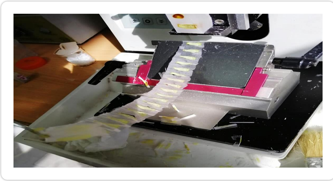
صورة (3-4) جهاز المايكروتوم وعملية التقطيع النسجي
