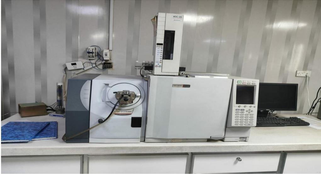
شكل (3-6) صورة لجهاز الكروماتوغرافيا الغاز - مطياف الكتلة (GC/MS) Gas
