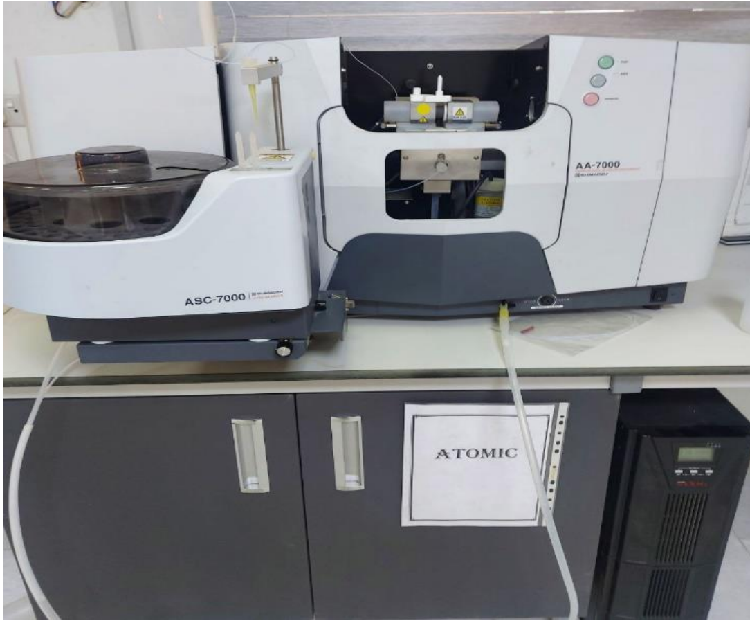
الشكل (1-2) جهاز الامتصاص الذري بتقنية فرن الكرافيت
