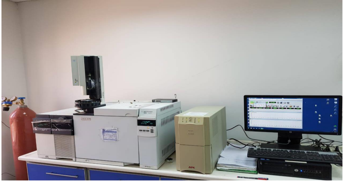
صورة ( 3-4) صورة لجهاز كروماتوغرافيا الغاز - مطياف الكتلة Gas Chromatography- Mass Spectrometry (GC-MS).
