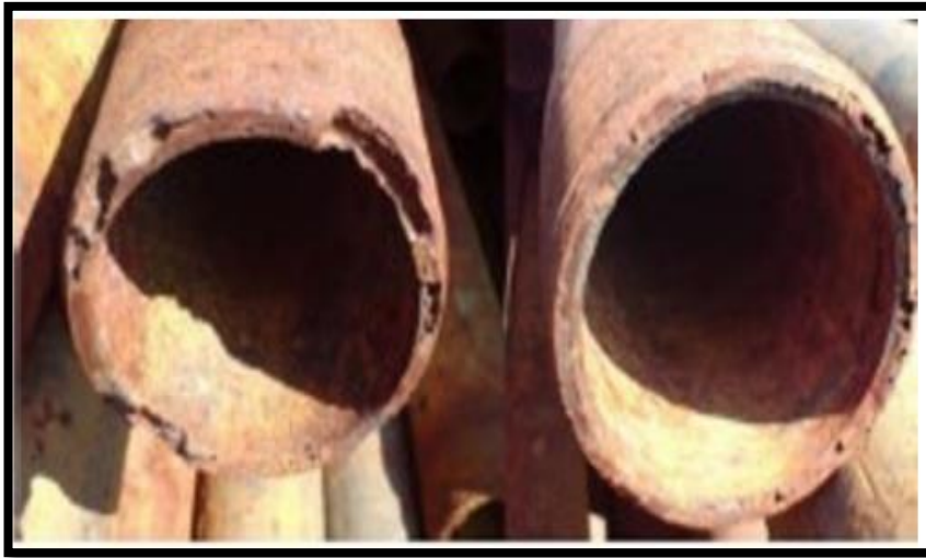
الشكل (1-6) التآكل بالحث (التعرية) [43].
