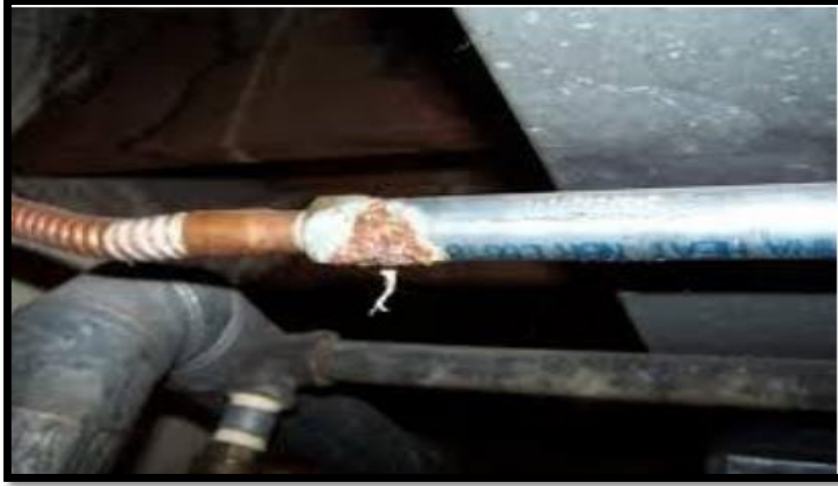
الشكل (1-2) التآكل الكلفاني [29].
