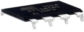
شكل (15) يوضح وحدة المعالج الدقيق المصغر (Attiny85)
