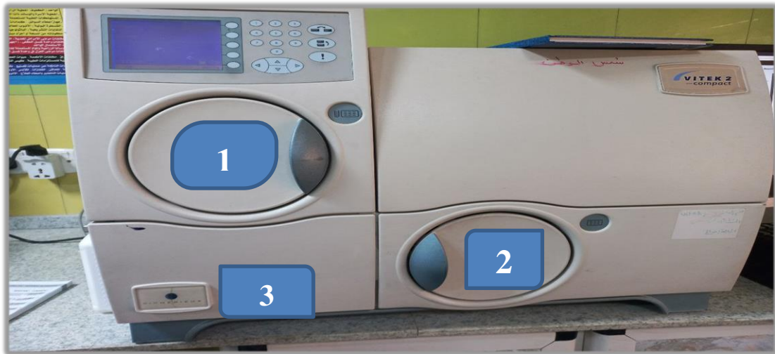
Figure: (2-2) :VITEK 2 System (1) Fill Door , (2) User Access door,(3) waste door
