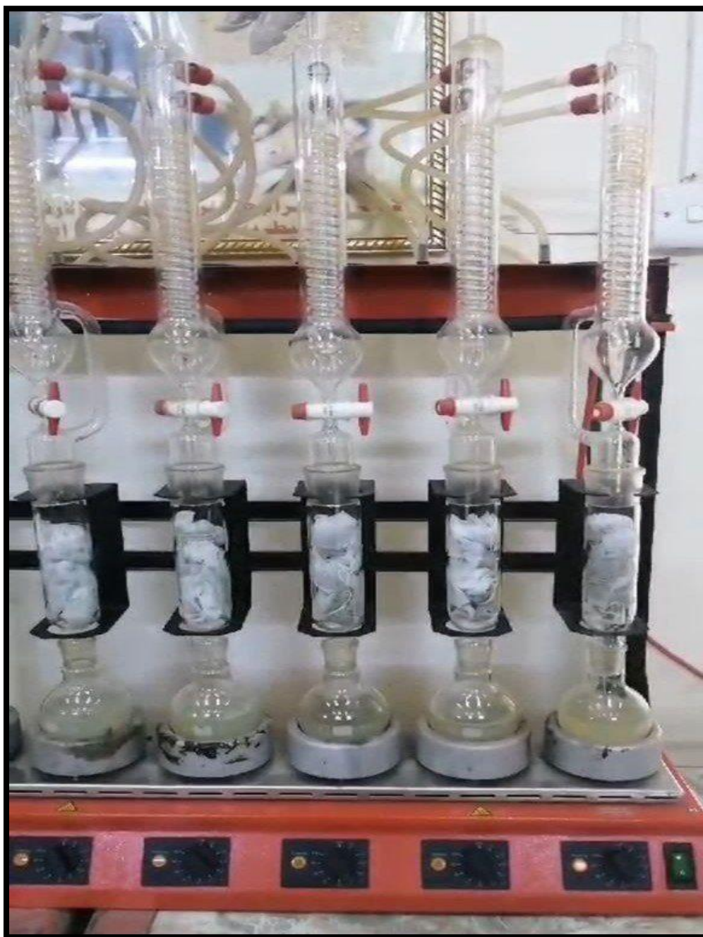
الصورة 3: توضيح العمل المختبري لقياس نسبة الزيت
