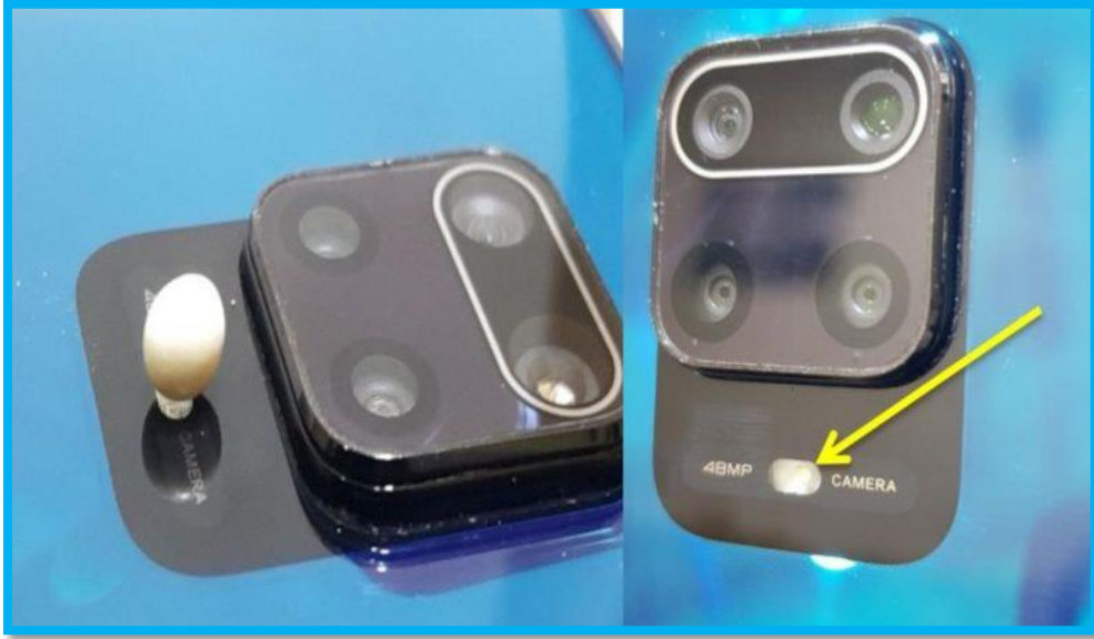
الصورة ( 3 - 3 ): آلية فحص التطور الجنيني داخل البيوض
