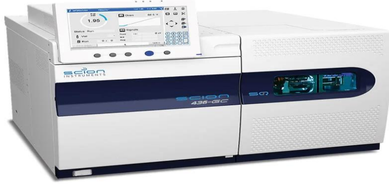
لوحة (3-3) صورة لجهاز كروماتوغرافيا الغاز- مطياف ال كتلة Gas Chromatography- Mass Spectrometry (GC-MS)
