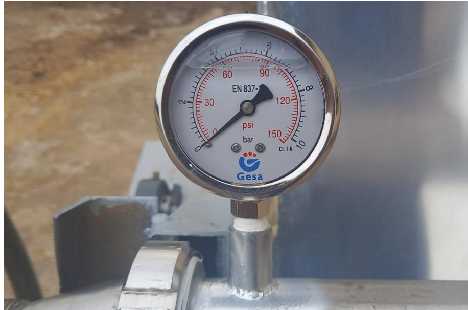
Figure (4-8): Gesa (EN 837-1) pressure gauge.
