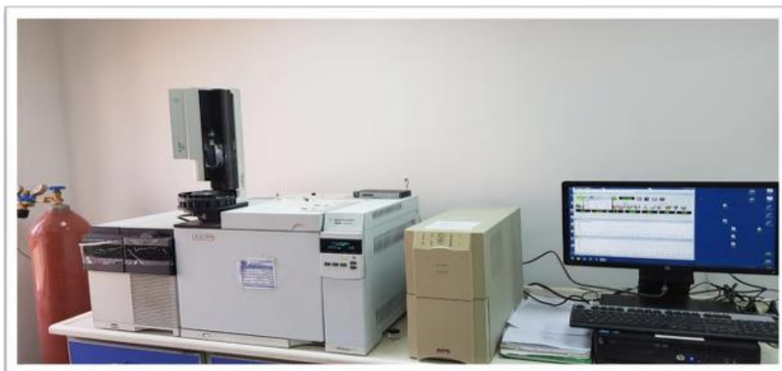
صورة (3-3) جهاز كروماتوغرافيا الغاز - مطياف الكتلة Gas Chromatography- Mass Spectrometry (GC-MS)
